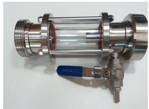
Image 1 : Injecteur permettant la désoxygénation du vin à l'azote
