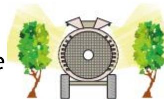
Aéroconvecteur à flux axial
